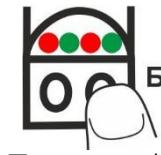
Повторным нажатием кнопки Б задержка выключения отменяется и задается режим работы без задержки. При этом будут светиться все индикаторы.
