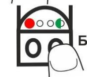
При нажатии на кнопку Б устанавливаются секунды задержки (одно нажатие - одна секунда). При каждом нажатии кнопки будет вспыхивать индикатор состояния зеленого цвета.
