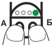
После выбора нужного режима работы нажмите кратковременно обе кнопки А и Б. Выключатель перейдет в рабочий режим. Будет светиться индикатор состояния зеленого цвета.
