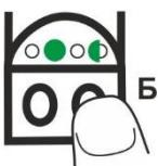
**Не рекомендуется увеличивать расстояние срабатывания более 1,5Sn.** При установлении предельного расстояния срабатывания будет светиться индикатор состояния красного цвета. Данный режим может быть использован при настройке оборудования.
