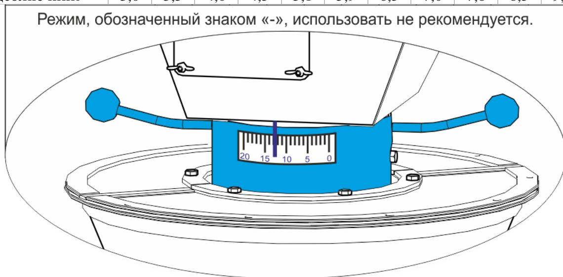
Перед регулировкой необходимо определить размеры тары. Подготовить ее для взятия и взвешивания проб семян. Точность измерения производительности дозатора семян увеличивается с увеличением объема тары. Поэтому для отбора проб семян рекомендуется тарованный кузов автомобиля.
